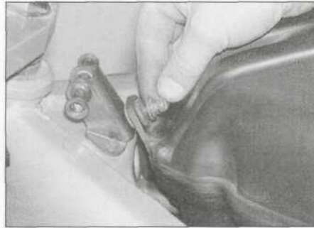
4.3a Unscrew the bolt. . .
